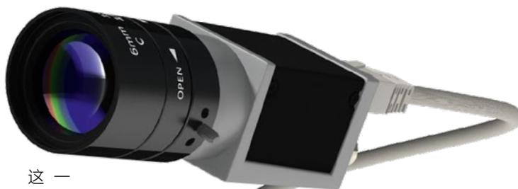
这一协议使得多台相机能够设置为PTP模式，实现彼此间精确到微妙级且实时的同步。实现此功能的方式是设定一台设备作为主设备，其时钟为其他设备的时间戳设定基准。通过GPS，甚至可以让以太网网络中的相机及其他设备在全球范围内实现同步。
